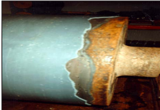
Delaminación en la transición de la placa cobertora.
